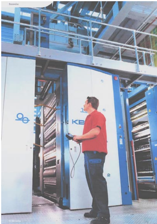
Das mittels flexibler Steuerkonsole Auseinanderfahren der KBA-Cortina-Druckeinheit für bessere Zugänglichkeit. Untertützt wird dies noch durch den getriebefreien Mehrmotorenantrieb.
