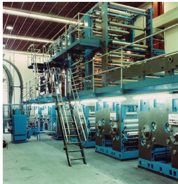
Eine „Super-Nova“-Zeitungsflexodruckrotation von Cerutti, wie sie heute noch in Italien häufig anzutreffen ist.
