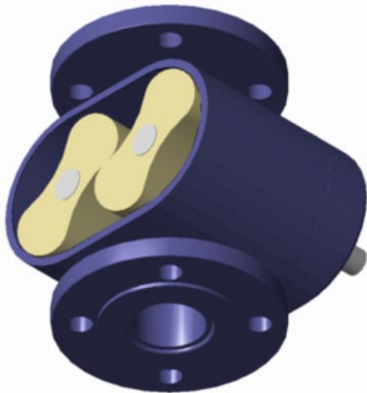
Der prinzipielle Aufbau und eine 3 D-Darstellung des Roots-Gebläses/Kompressors.
